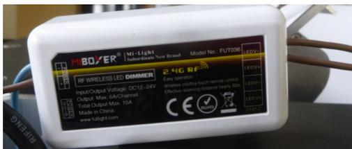
15. Verbinden Sie die in den Pfosten eingeführten LED-Band-Kabel mit dem Steuerungsmodul (Zeichn.12). Achten Sie darauf, genügend Kabellänge zu lassen, damit das Steuerungsmodul über dem Netzteil platziert werden kann und der richtige Anschluss gemäß den Markierungen auf dem Steuerungsmodul erfolgt.
