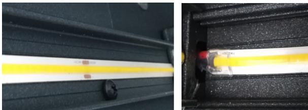
11. Nachdem Sie das Band auf die gewählte Länge zugeschnitten haben (siehe Punkt 9), sichern Sie das abgeschnittene Ende, um die Schutzart IP65 aufrechtzuerhalten. Tragen Sie Silikon auf das abgeschnittene Ende auf und setzen Sie die transparente Kappe auf das Band (Zeichn. 8A).
